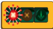
Controlesignaal: Geplaatst boven rijstroken om aan te geven welke open zijn om te rijden. Hier: ROOD = niet rijden op rechter rijstrook.
